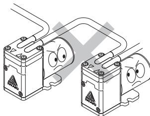
● 请不要将 2 台以上的泵串联使用。否则可以导致不能启动，甚至烧毁电机。
