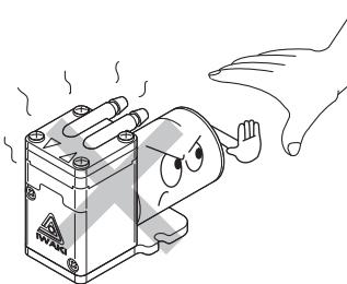
● 在运行中，电机和泵的表面温度会升高，并非异常。请勿用手直接接触，也不要将会受热变形的物品放在附近。
